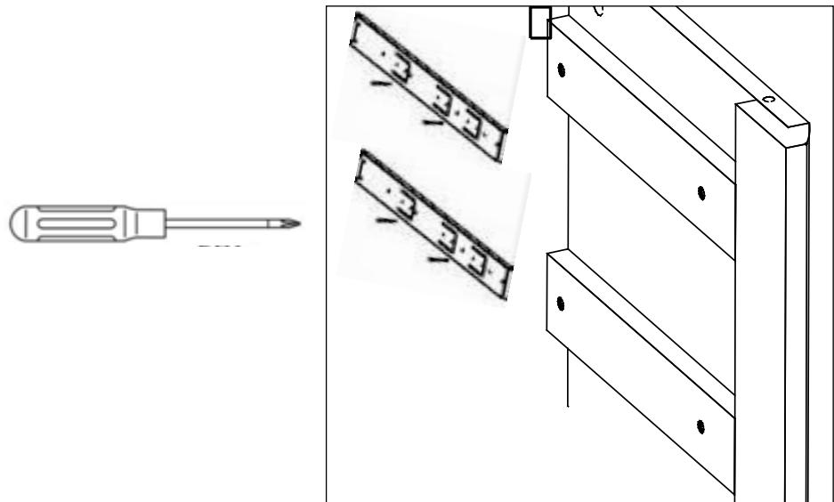
4. Вкрутить стержни эксцентриков (М) во втулки, забитые в отверстия на крышке (1).
