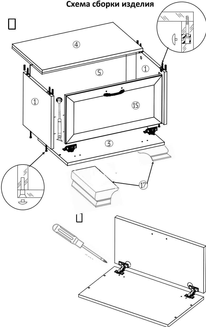
1. Закрепить на нижней части опор (17) подпятники (N) шурупами (Z) на расстоянии ≈3 см от края.
