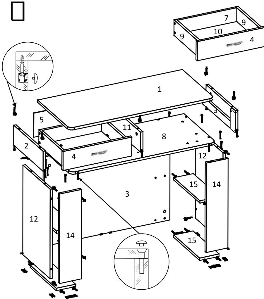
1. Закрепить на нижней части боковин (12), опор (14) и задней стенки (13) подпятники (J) шурупами (Z) на расстоянии  $\approx 3$  см от края.
