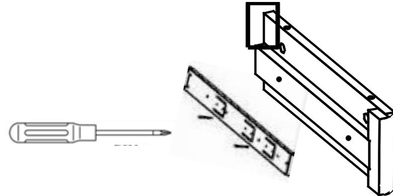
4. Вкрутить стержни эксцентров (M) в предварительно забитые втулки в отверстия на крышке (1) боковинах (12), опорах (14) и задней стенке (13).
