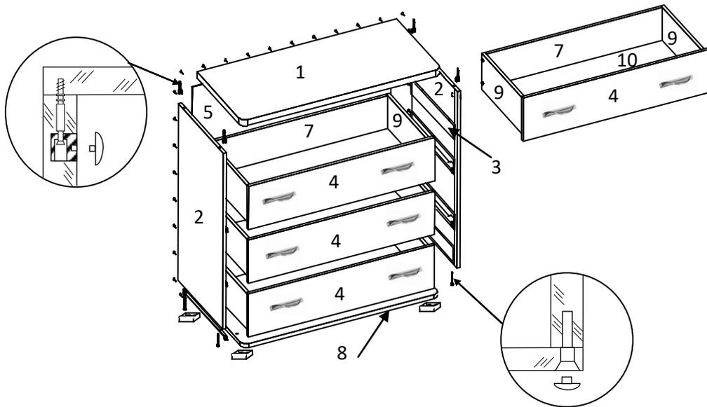
1. На нижней части дна (8) прикрепить регулируемые опоры (С) шурупами (D).
