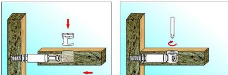
4. Вкрутить стержни эксцентриков (М) во втулки, забитые в отверстия на крышке (1).
