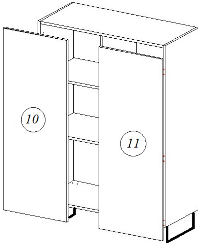
1. Закрепить планки петель ( **H** ) при помощи саморезов ( **D** ) на боковой стенке ( **3, 4** ).
