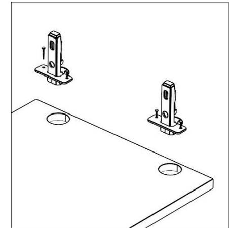
5. Вкрутить стержни эксцентриков (J) в отверстия на крышке (6) и боковинах (1,2).
